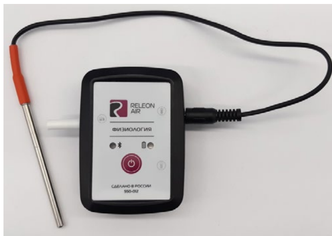
Рис. 12. Датчик температуры тела
